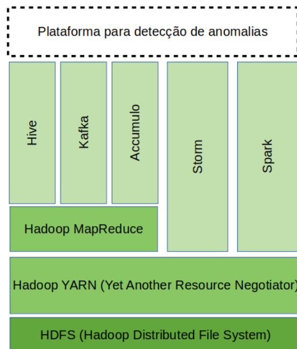
Figura 2: esquema conceitual das ferramentas utilizadas que fazem parte do ecossistema Hadoop
