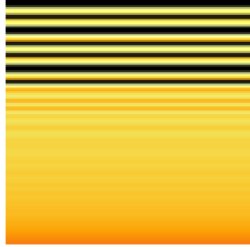
Fig. 1. Exemplo de Mel-spectrograma gerado a partir de features de tráfego de rede no dataset UNSW-NB15. A imagem codifica variações temporais de múltiplas features de rede em um mapa tempo-frequência.
