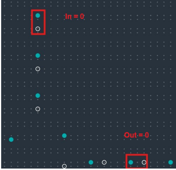
Fig. 1. Fio 1U1R, que propaga o sinal de entrada que vem de cima para a direita. Note o estado dos pares de DBs de entrada e saída, propagando o 0 lógico (correspondente ao elétron orbitando o DB mais à esquerda em um par horizontal ou mais acima em um par vertical)
