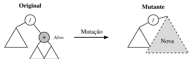
Fig. 6. Operador de Mutação de Subárvore: uma parte da árvore é removida e substituída por uma nova estrutura gerada aleatoriamente (triângulo tracejado).
