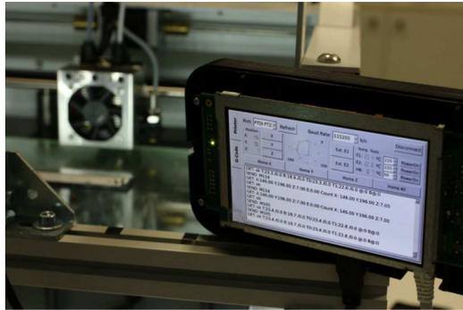
Figura 2.2 – Plataforma HMI para controle de impressora 3D (ARDANZA et al., 2019)
