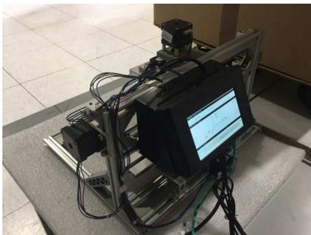
Figura 2.3 – Interface HMI para cortador a laser
