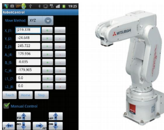
Figura 2.1 – Aplicação para controle remoto de braço robótico ([PAPCUN; ČOPÍK, 2012](#))
